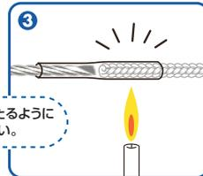
チューブを収縮させていない方に、新しいロープの先を差し込み、後に差し込んだ部分に再び熱を加えて収縮させます。
