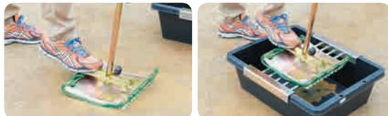
水吸取器のフットバーを足で踏むことにより、スポンジが収縮し、スポンジが復元するときに、地表の水を吸います。専用バケツ(D150)又は側溝等の上で、水吸取器のフットバーを足で踏むことにより、スポンジに吸い込まれた水が排出されます。
