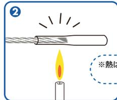
旧ロープに収縮チューブを半分ぐらい差し込んだ後、熱を加えて収縮させます。この時、旧ワイヤーロープを差し込んでいる部分だけに熱を加えてください。
